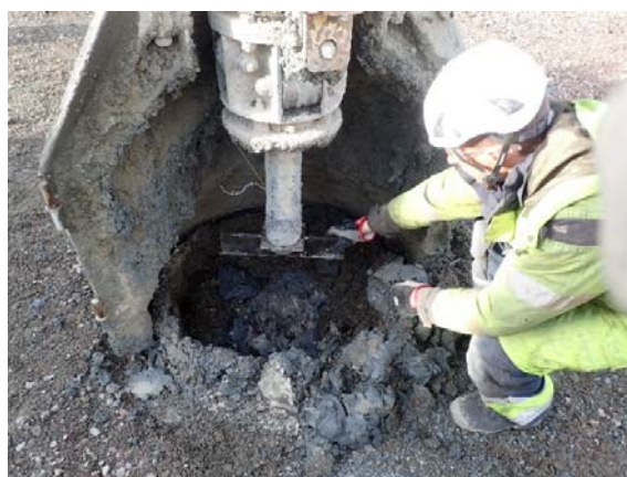
Figur 30 Elektrod-kabeln förankrades i botten på KC-pelaren med hjälp av FOPS-vinge vid försöken på Västlänken (Foto: Mikael Lumetzberger).
