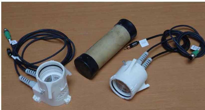
Figur 12. a) Lock med elektroder och temperaturgivare för icke-förstörande mätning av resistivitet på material i provtagningscylindrar enligt SGF-standard, och b) använd numrering av elektroderna.
